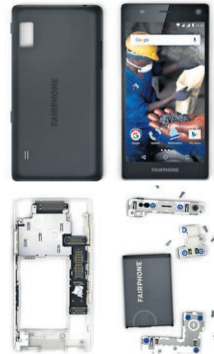
Toutes les pièces principales du Fairphone 2 sont facilement démontables. L'appareil coûte environ 580 fr. DR
